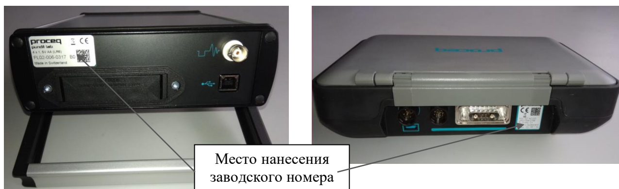
Рисунок 2 – Обозначение места нанесения заводского номера (Pundit Lab+ - слева, Pundit PL-200 – справа)
