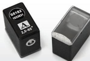
**S5182 2.5A65D12CS** — наклонный совмещенный преобразователь для дефектоскопии сварных швов изделий из металла при толщине объекта контроля от 12 до 30 мм.
