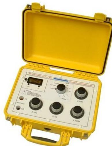
Прецизионный калибратор 5069 используется для калибровки и поверки универсальных тестеров изоляции с испытательным напряжением до 10 кВ.
