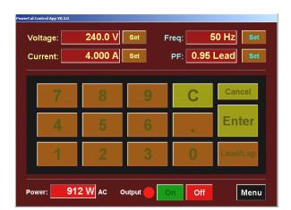
Power Cal управляется дистанционно с ПК посредством интерфейса RS232. Удобная виртуальная панель управления позволяет индивидуально устанавливать каждый из четырёх параметров. Частота может устанавливаться шагами по 0,1 Гц в диапазоне от 40 до 400 Гц. Фаза устанавливается шагами по 0,1 градуса. Коэффициент мощности также может устанавливаться шагами по 0,01. Выходное значение может быть отображено в ВА и Ватт.
