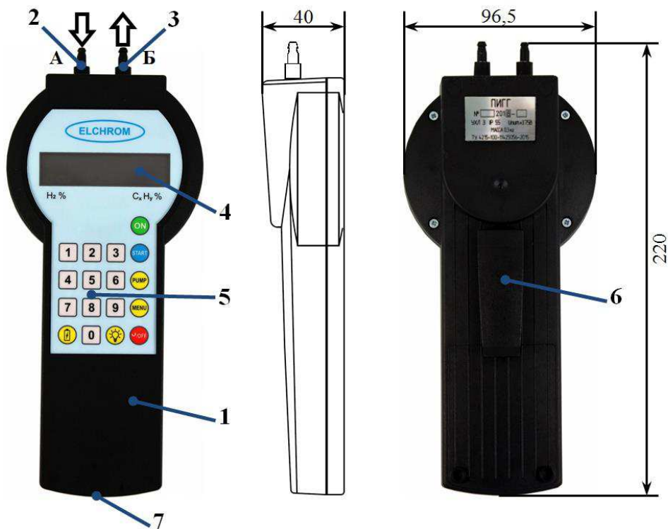
Рисунок 1. Общий вид и габаритные размеры прибора «ПИГГ»
