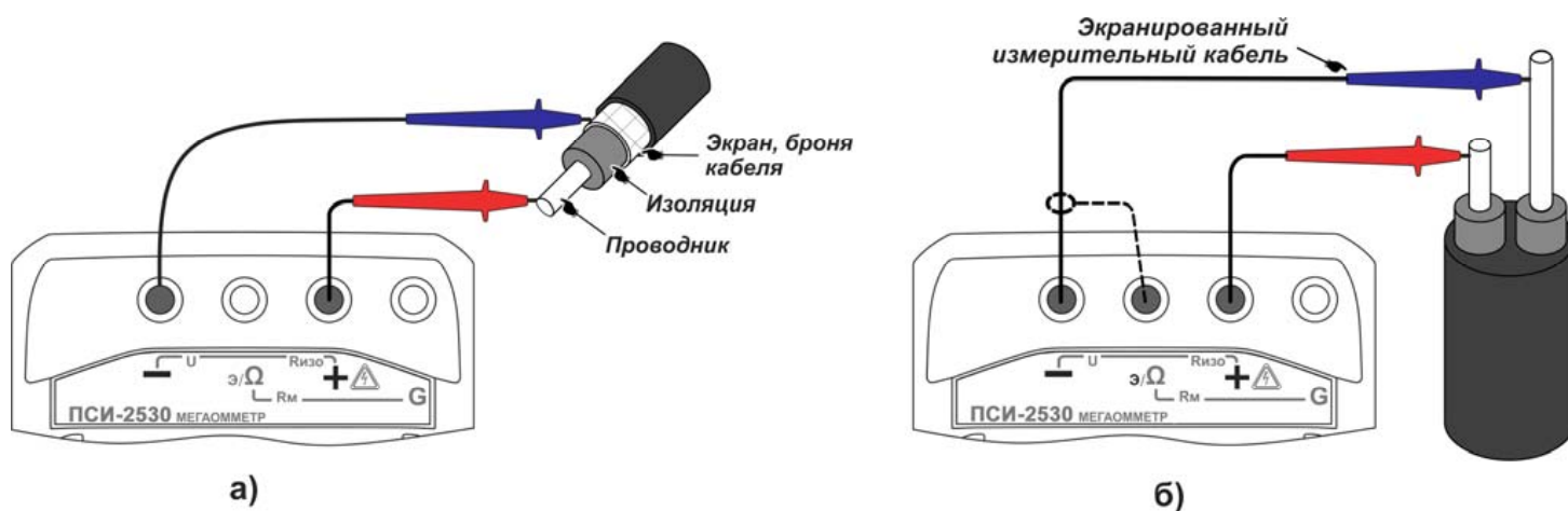
Рисунок 2.5 – Измерение сопротивления изоляции кабеля
