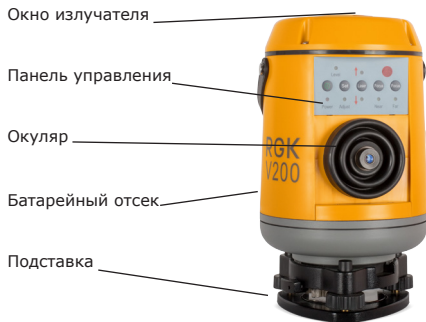
Рис. 2. Корпус устройства вертикального проектирования
