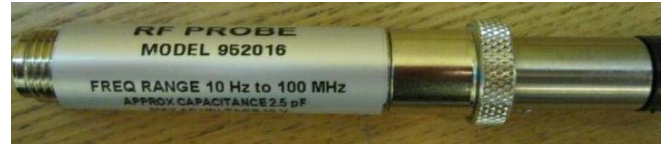
Измерительный зонд 952016 (диапазон частот от 10 Гц до 100 МГц)
