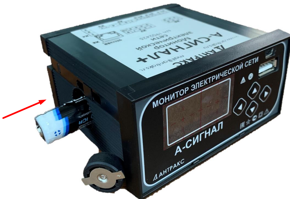
Рисунок 4.2 Вставить резервную батарею в корпус прибора
