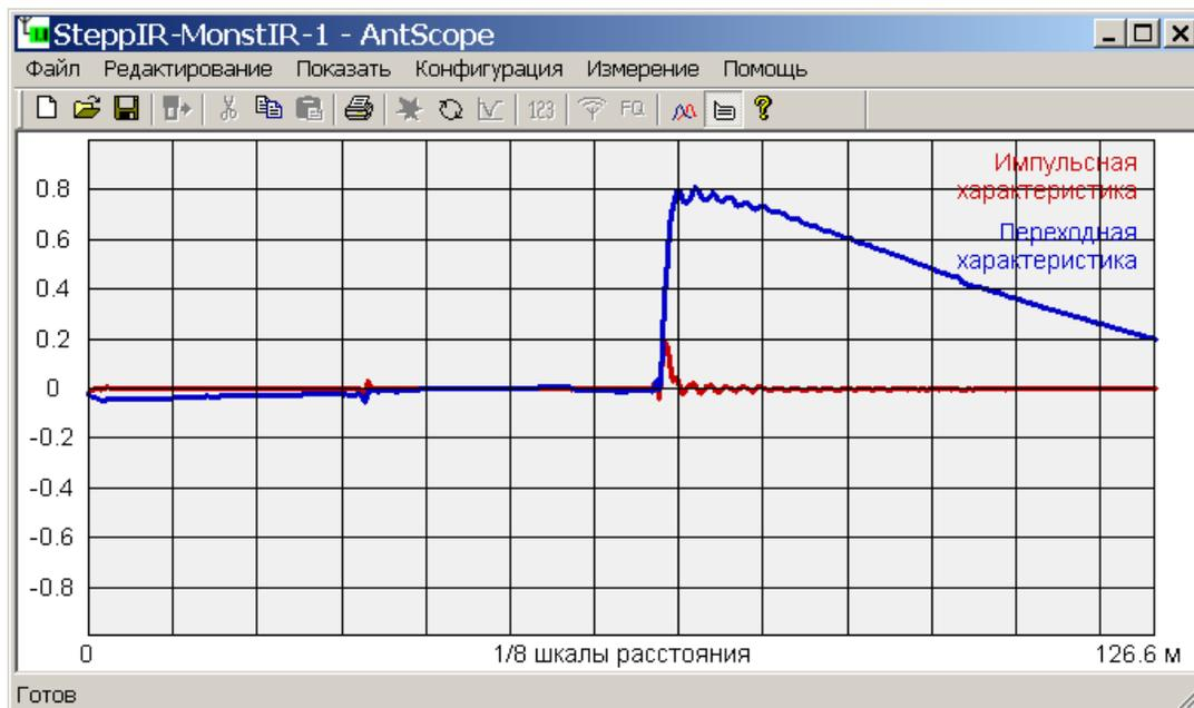
Графики импульсной и переходной характеристик не позволяют назвать точную причину неоднородности, но помогают определить расстояние до нее. Экспериментируя с различными кабелями, переходниками и антеннами, можно увидеть, как те или иные неоднородности отображаются на графиках.
