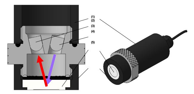
Измеритель состоит из компактного датчика в корпусе (1) расположены источник света (3), фотоприемник (2). Сменная насадка (4) с нанесенным красителем, фиксируется колпачком (5). а также измерительного преобразователя.
