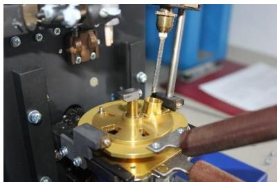
❖ Высокоточная система фиксации температуры вспышки. Автоматическое определение вспышки при помощи малоинерционной термопары, а также введение поправки на атмосферное давление по показаниям встроенного датчика обеспечивают точное определение температуры вспышки в диапазоне от +12 до 370 °C
