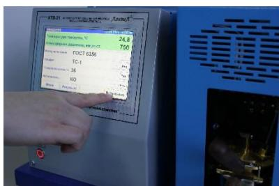
❖ Простота эксплуатации и обслуживания. Автоматическое размещение датчиков и исполнительных устройств в тигле. Достаточно установить заполненный тигель, выбрать необходимую программу испытаний и нажать кнопку «Испытание»
