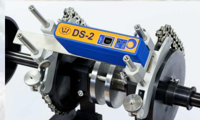
Центровщик марки DS-2 (универсальное приспособление для центровки валов в агрегатах) предназначен для центровки валов механизмов в агрегатах малой и средней мощности. В отличие от большинства лазерных устройств, представленных на рынке, центровщик DS-2 более компактен, проще в работе, имеет меньшую стоимость.
