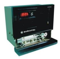
Предназначен для измерений объемной доли влаги в азоте, кислороде, водороде, углекислом газе, воздухе и их смесях, а также в инертных и других газах, не взаимодействующих с фосфорным ангидридом, и представляет собой цифровой стационарный прибор непрерывного действия.
