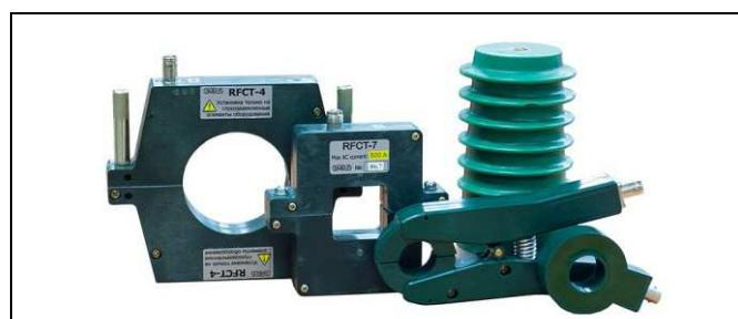
Первичные датчики, предназначенные для контроля частичных разрядов и токов «ЧР» и токов утечки в экране «И», представляют собой кольцевые трансформаторы тока. Сердечник датчика контроля частичных разрядов изготавливается из высокочастотного феррита, а для датчика тока промышленной частоты используется сердечник из электротехнической стали.
