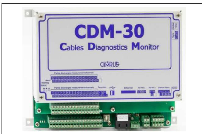
В приборе CDM контроль технического состояния высоковольтной изоляции кабельных линий, соединительных и концевых муфт, осуществляется с использованием метода регистрации и анализа частичных разрядов. Этот метод имеет максимально высокую чувствительность и эффективность для диагностики большинства дефектов в высоковольтных кабельных линиях с изоляцией любого типа.
