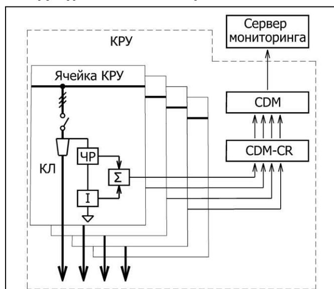
Для практической реализации системы обслуживания кабельных линий по техническому состоянию используются приборы CDM и CDM-CR, а также специализированное программное обеспечение мониторинга и диагностики марки INVA. Расположение первичных датчиков, технических и программных средств системы мониторинга КЛ показан на рисунке.
