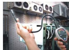
Наличие автоматического режима не требует никакого вмешательства оператора в процесс обнаружения негерметичных мест в патрубках морозильных камер, систем охлаждения и кондиционирования. Приборы имеют высокую устойчивость к наличию фоновых загрязнений, что значительно уменьшает число случаев ложного срабатывания.
