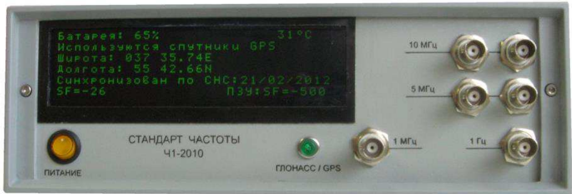
Рисунок 6.1. Индикация и расположение органов управления, присоединительных разъемов на передней панели стандарта частоты рубидиевого Ч1-2010.
