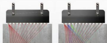
В приборе используется метод синтезированной фокусируемой апертуры с комбинационным зондированием (САФТ-К), при котором происходит фокусировка ультразвука в каждую точку полупространства. Массив данных формируется путем сбора информации со всех измерительных пар антенного устройства томографа.
