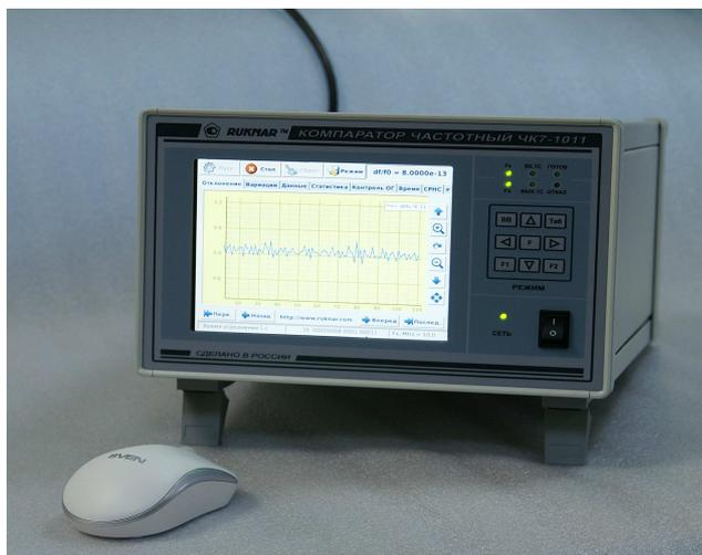
Компараторы частотные ЧК7-1011 предназначены для измерения относительной разности частот прецизионных кварцевых генераторов и рубидиевых стандартов частоты, вычисления их основных метрологических характеристик с отображением процесса и результатов измерений на экране встроенного цветного дисплея.
