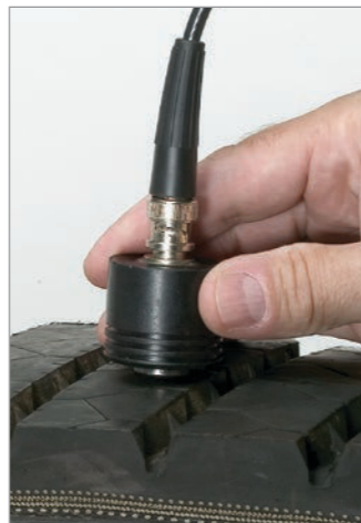
Измерение глубины залегания стального/плетеного корда в резиновых конвейерных лентах и автомобильных покрышках.
