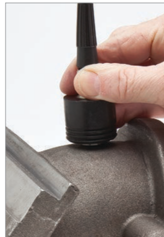
Опция повышенного проникновения позволяет измерять толщину массивных литых деталей или материалов с высоким затуханием звукового сигнала.
