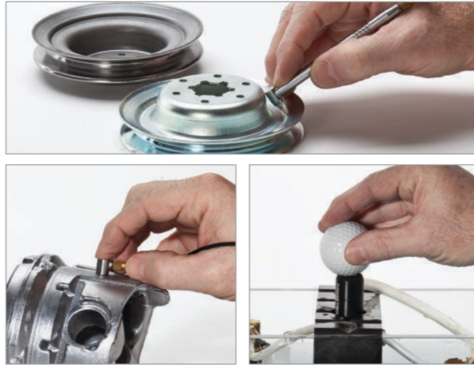
Ультразвуковой метод измерения толщины обеспечивает точные, надежные и воспроизводимые результаты. Измерения выполняются с одной стороны материала без разрезания или разрушения детали.
