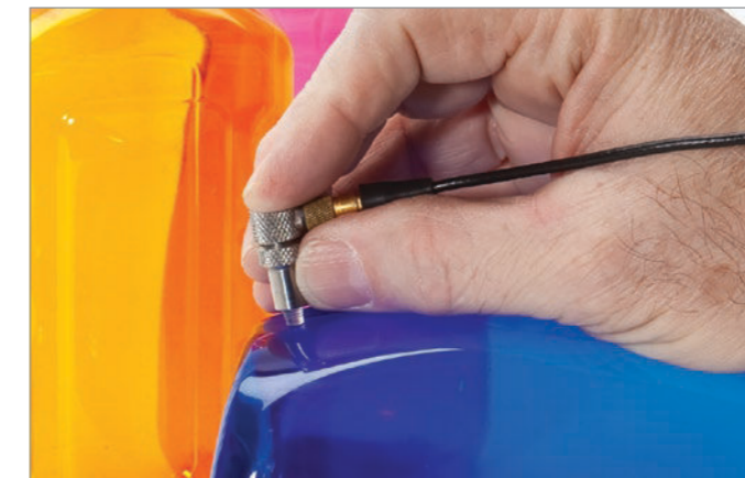
Измерение тонкого пластикового материала с помощью преобразователя с линией задержки (частотой 20 МГц).
