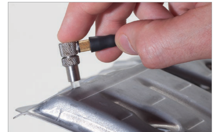
Измерение утонения металла после формования.
