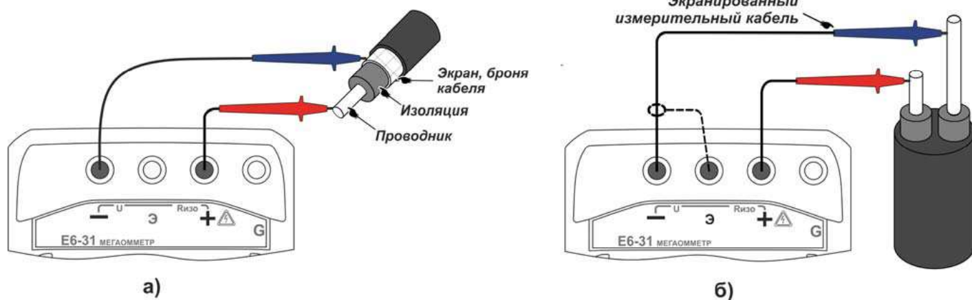
Рисунок 2.11 – Измерение сопротивления изоляции
