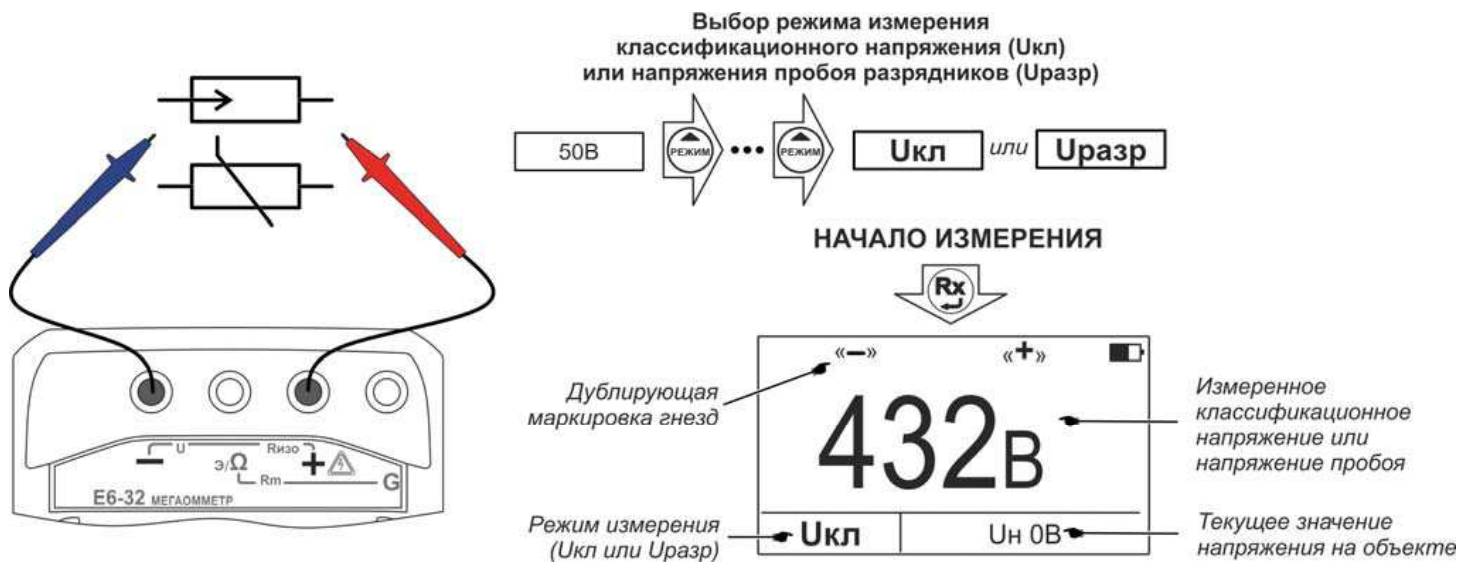
Рисунок 2.10 – Измерение классификационного напряжения или напряжения пробоя разрядников
