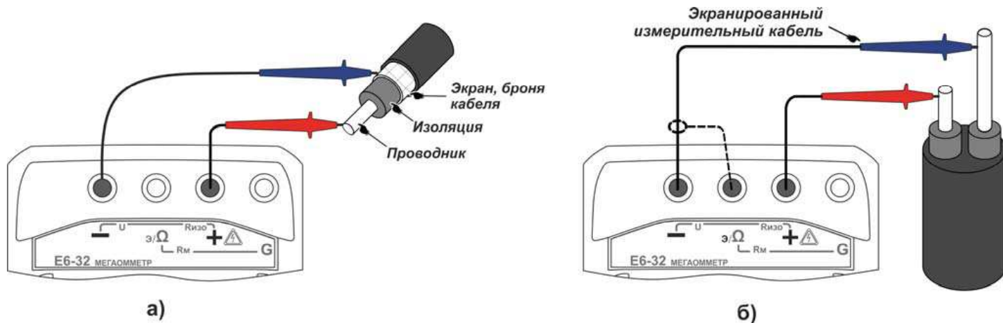
Рисунок 2.5 – Измерение сопротивления изоляции кабеля
