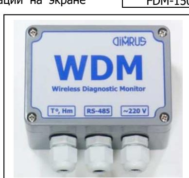
Итоговые результаты работы экспертной системы FDM о состоянии электродвигателя передаются по радиоканалу в систему АСУ-ТП.
