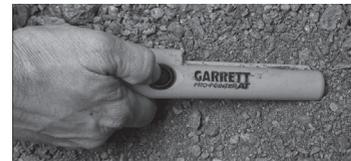
Функция Быстрой перенастройки помогает быстро убрать отклик от минерализованного грунта, солёной воды, мокрого песка и других сложных для поиска сред.
