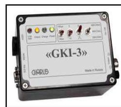
калибровочные импульсы повышенной мощности. С этой целью выходной сигнал генератора имеет повышенное напряжение - до 400 вольт. Величина выходного напряжения импульсов выбирается пользователем исходя из требуемых условий проведения калибровочных работ на конкретном высоковольтном оборудовании. Пользователь также может сам выбрать длительность выходного импульса калибровочного генератора «GKI-3», что также способствует расширению зоны его применения.
