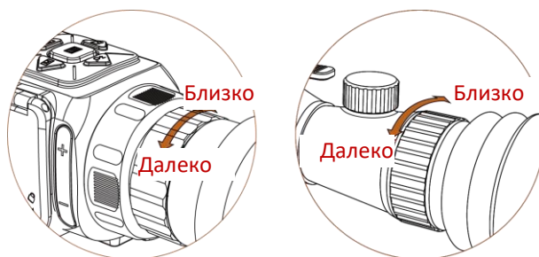
Рис. 3-1. Регулировка кольцом фокусировки
