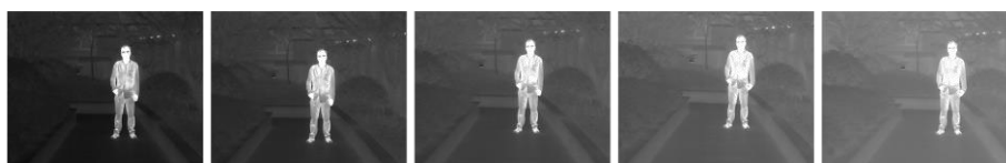
Рис. 3-2. Настройка яркости в режиме «Горячее – белое»
