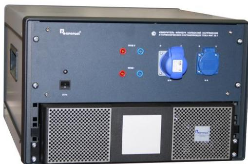
**Измеритель фликера, колебаний напряжения и гармонических составляющих тока ИФГ 20.1М**
