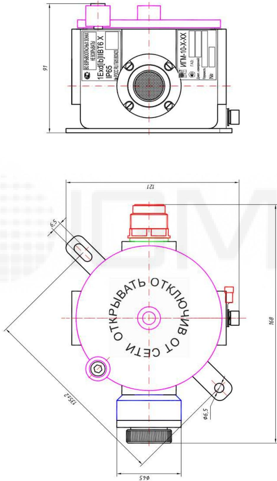
Рисунок Д.1 - Габаритный чертеж ИГМ-10-Х-11.
