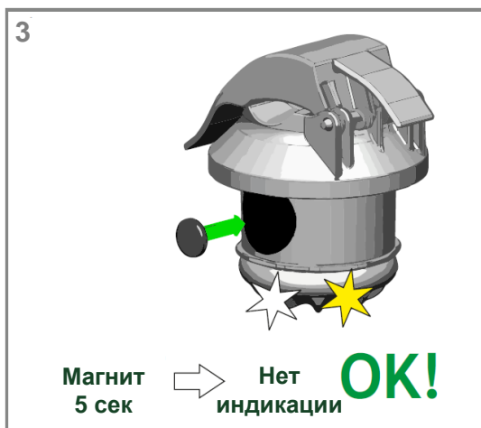
Рисунок 10 – Тестирование индикатора ИКЗ-В31Л
