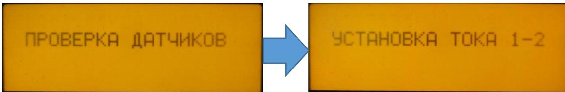
После запуска разряда, BSL-4-12/20 проверит датчики температуры/напряжения и перейдет к испытанию с мониторингом.
