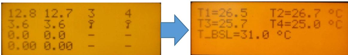
Во время испытания разряда нажмите кнопку «3» для просмотра состояния температуры АКБ, а так же температуры РДУ CONBAT BSL.
