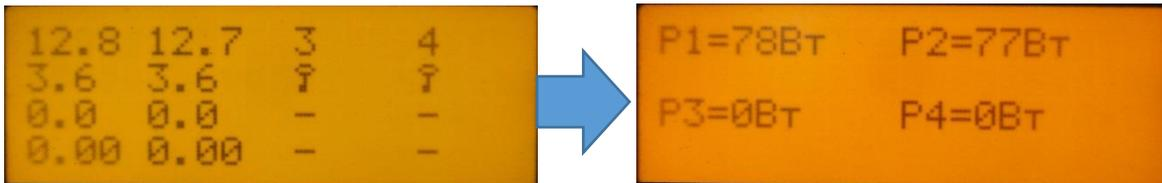
Во время испытания разряда нажмите кнопку «1» для просмотра мощности разряда в ваттах.
