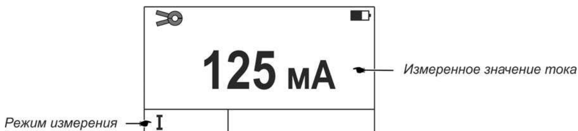
Рисунок 2.13 - Вид индикатора при измерении переменного тока
