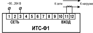
Рисунок 5.3 – Схема подключения с трансформатором
