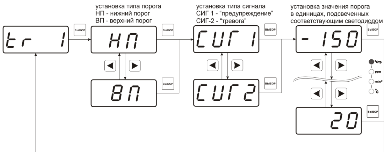
Рисунок 6.5 Схема задания порогов по температуре (влажности, давлению)
