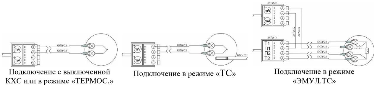
При подключении поверяемого (калибруемого) прибора к КИТ-1 в режиме с выключенной КХС, в режиме «ТЕРМОС.» и в режиме «ТС» сигнал с КИТ-1 подается непосредственно на вход поверяемого (калибруемого) прибора. Дополнительно в режиме «ТС» к разъему измерительного входа для электрического сопротивления, ТС и ТП подключается термометр сопротивления – КИТ-ТС1, предназначенный для измерения температуры поверяемого (калибруемого) прибора.
