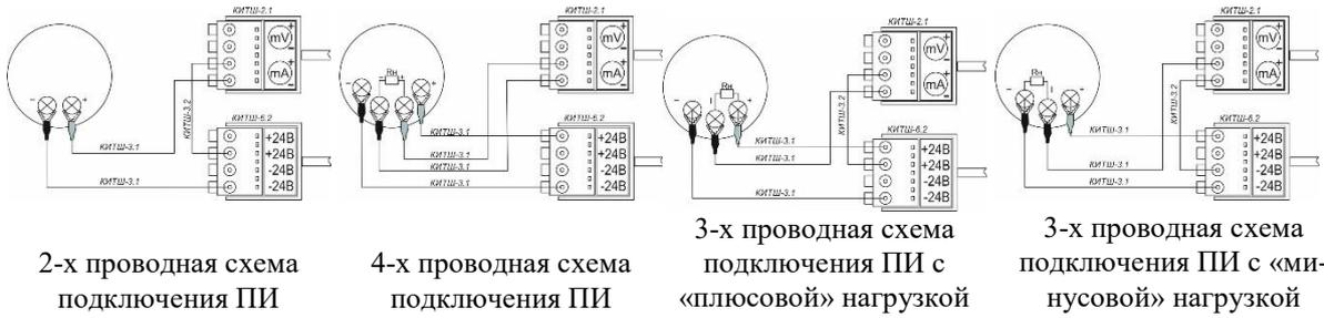
При подключении измерительных преобразователей (ПИ) используются: шнур КИТШ-2.1, подключенный к разъему измерительного входа для напряжения, силы тока, ПИ и реле; шнур КИТШ-6.2, подключенный к разъему блока питания 24 В, и несколько шнуров КИТШ-3.1, КИТШ-3.2. Блок питания 24 В необходимо включить в настройках прибора (п. 4.1.6.5).
