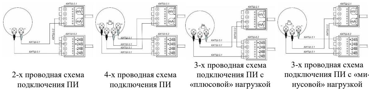
При подключении измерительных преобразователей (ПИ) используются: шнур КИТШ-2.1, подключенный к разъему измерительного входа для напряжения, силы тока, ПИ и реле; шнур КИТШ-6.2, подключенный к разъему блока питания 24 В, и несколько шнурков КИТШ-3.1, КИТШ-3.2. Блок питания 24 В необходимо включить в настройках прибора (п. 4.1.6.5).
