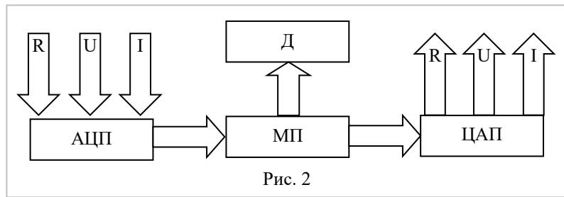
В режиме измерений датчики должны быть подключены к разъему измерительного входа для электрического сопротивления, ТС и ТП и/или к разъему измерительного входа для напряжения, силы тока, ПИ и реле. Сигнал электрического сопротивления «R», напряжения «U» или силы тока «I» попадает на вход аналого-цифрового преобразователя (АЦП). После преобразования входного сигнала полученную информацию обрабатывает микропроцессор (МП). Результаты измерений отображаются на дисплее.
