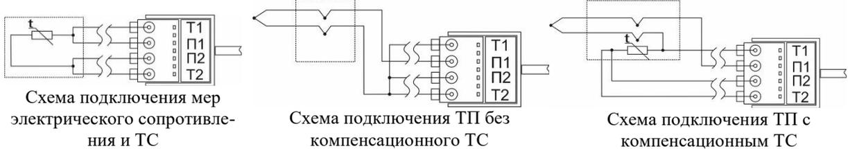
Меры электрического сопротивления и термометры сопротивления (ТС) подключаются к КИТ-1 по 4-х проводной схеме при помощи шнура КИТШ-1.1.
