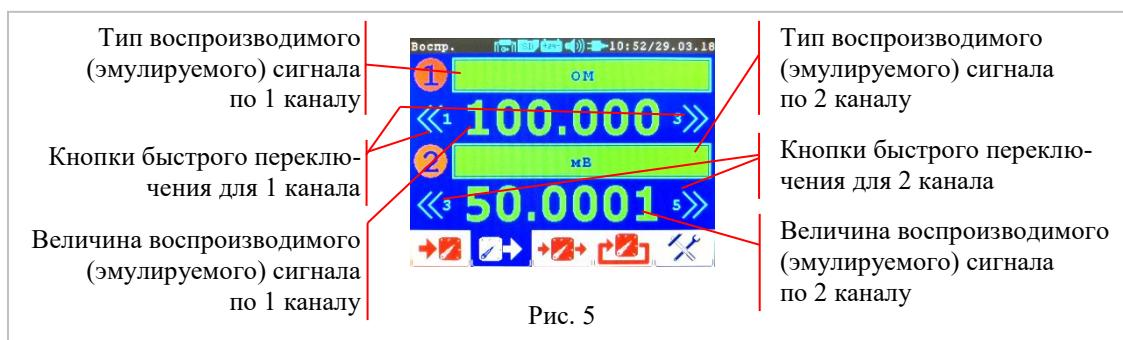
4.1.3.1 Нажатие на сенсорную кнопку «Тип воспроизводимого (эмудирируемого) сигнала по 1 каналу» откроет меню выбора. Возможные варианты: «ВЫКЛ», «ОМ», «НСХ ТС».
