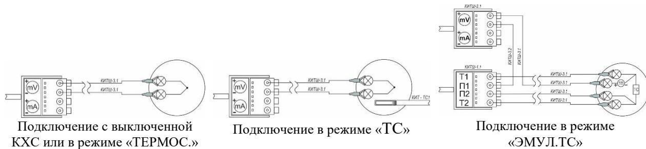
При подключении поверяемого (калибруемого) прибора к КИТ-1 в режиме с выключенной КХС, в режиме «ТЕРМОС.» и в режиме «ТС» сигнал с КИТ-1 подается непосредственно на вход поверяемого (калибруемого) прибора. Дополнительно в режиме «ТС» к разъему измерительного входа для электрического сопротивления, ТС и ТП подключается термометр сопротивления – КИТ-TC1, предназначенный для измерения температуры поверяемого (калибруемого) прибора.
