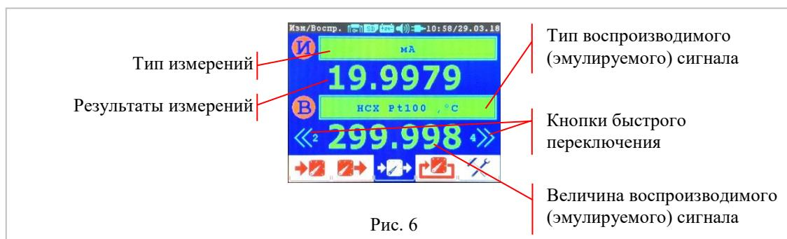
4.1.4.1 Нажатие на сенсорную кнопку «Тип измерений» откроет меню выбора. Возможные варианты: «ВЫКЛ», «ОМ», «мВ», «мА», «РЕЛЕ», «НСХ ТС», «ИСХ ТС», «НСХ ТП», «ИСХ ТП» и «ИЗМ. ПР».
