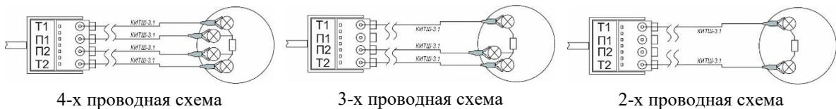
Для измерения сопротивления подводящих проводов при 2-х и 3-х проводной схеме воспроизведения (эмуляции) потребуется второй шнур КИТШ-1.1, подключенный к разъему измерительного входа для электрического сопротивления, ТС и ТП. Процедура запуска измерений описана в п. 4.1.6.6.
