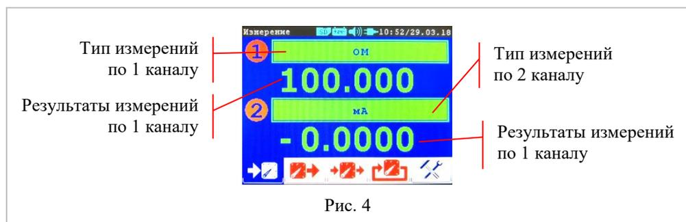
Вкладка «Измерение» предназначена для реализации режима измерений по двум каналам. При этом первый канал может измерять активное сопротивление и сигналы от датчиков температуры (ТС и ТП), в том числе эталонных; а второй - напряжение и силу постоянного тока; сигналы от преобразователей измерительных и реле.
