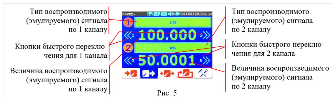
4.1.3.1 Нажатие на сенсорную кнопку «Тип воспроизводимого (эмулируемого) сигнала по 1 каналу» откроет меню выбора. Возможные варианты: «ВЫКЛ», «ОМ», «НСХ ТС».
