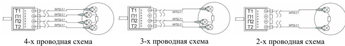
Для измерения сопротивления подводящих проводов при 2-х и 3-х проводной схеме воспроизведения (эмulationи) потребуется второй шнур КИТШ-1.1, подключенный к разъему измерительного входа для электрического сопротивления, ТС и ТП. Процедура запуска измерений описана в п. 4.1.6.6.
