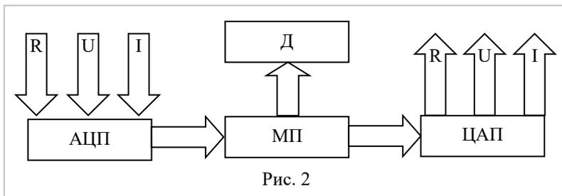
В режиме измерений датчики должны быть подключены к разьему измерительного входа для электрического сопротивления, ТС и ТП и/или к разьему измерительного входа для напряжения, силы тока, ПИ и реле. Сигнал электрического сопротивления «R», напряжения «U» или силы тока «I» попадает на вход аналого-цифрового преобразователя (АЦП). После преобразования входного сигнала полученную информацию обрабатывает микропроцессор (МП). Результаты измерений отображаются на дисплее.
