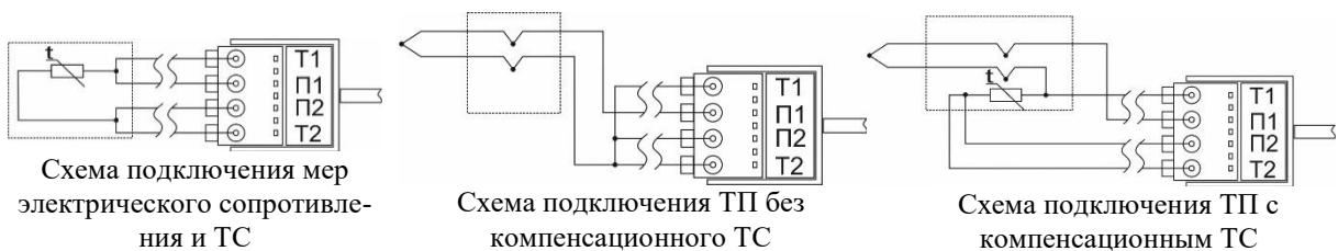
Меры электрического сопротивления и термометры сопротивления (ТС) подключаются к КИТ-1 по 4-х проводной схеме при помощи шнура КИТШ-1.1.
