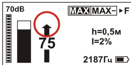
Проверку правильности отбора производят методом направления. Этот метод основан на том что в «чужих» кабелях ток течет в обратном направлении.
