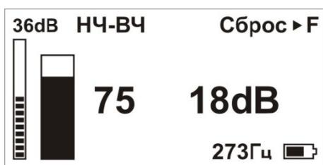
Сигнал «своего» кабеля отличается от соседних по величине и направлению. Чтобы уменьшить ток в соседних кабелях, используют низкую частоту генератора 273,5 Гц в режиме «НЧ-ВЧ». На приёмнике включите режим приемника «НЧ-ВЧ» и подключите клещи-отборник КО-29 или КО-100. Отбирайте «свой» кабель по величине сигнала.
