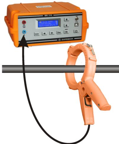
Когда подключение к кабелю затруднено (например, силовой кабель под напряжением), удобно подать в кабель сигнал генератора через клещи-индуктор К-100. Сигнал будет возбуждаться в контуре экран-земля и протекать через заземление экрана (или металлической оболочки) кабеля. Даже если кабель не заземлен, сигнал будет протекать на землю через емкость жила-земля, экран-земля.
