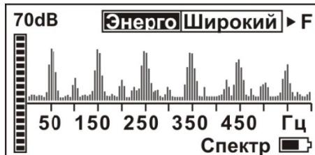
Отбор кабеля под нагрузкой проводят в режиме «**СПЕКТР**». Если это силовой кабель, следует установить режим «*Энерго*». Токи в трехфазном кабеле должны быть скомпенсированы. Однако часть электромагнитного поля все же выходит из кабеля и фиксируется приемником по характерным гармоникам промышленной частоты (50-100-150...Гц).
