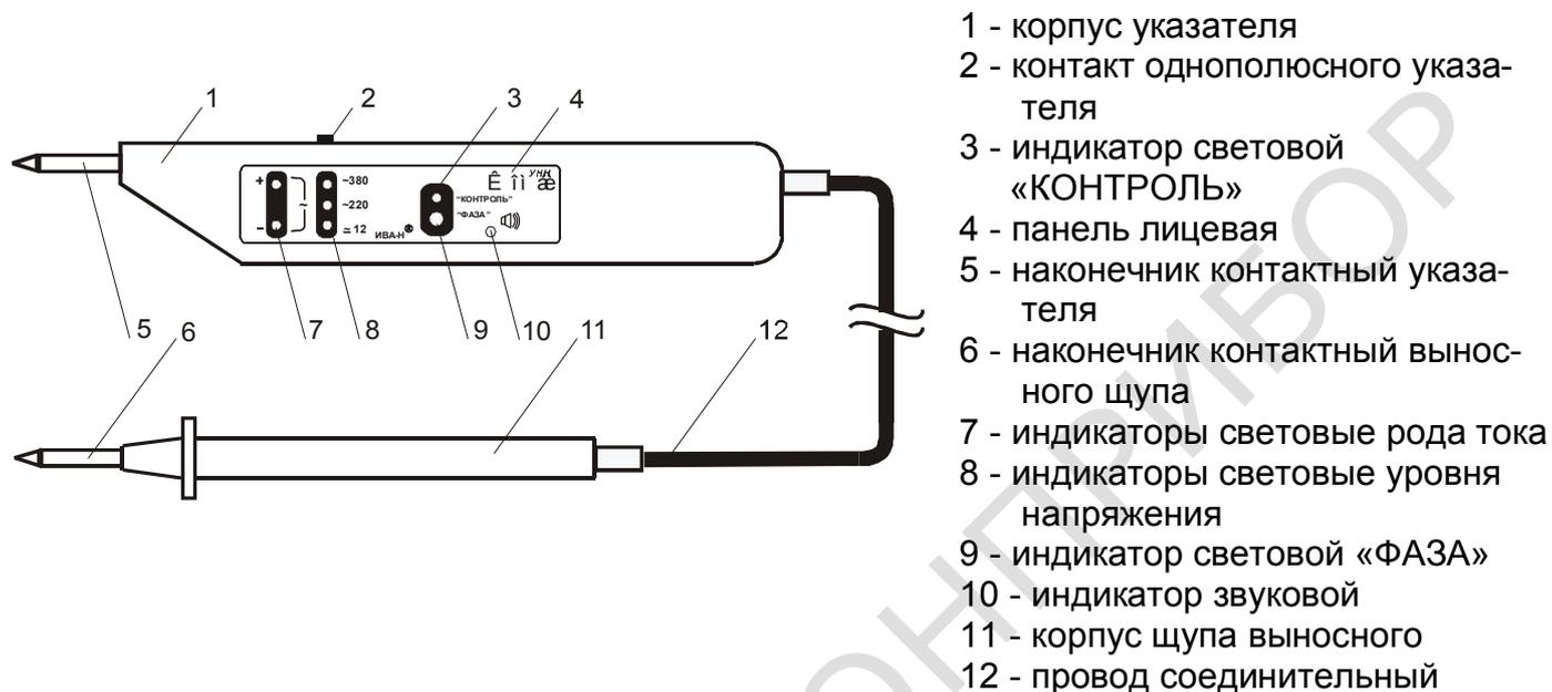
Рис. 1. Указатель напряжения УНН «Комби»
