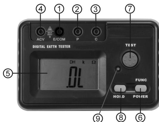
1. Порт "E/COM" (полюс заземления / отрицательная клемма измерения напряжения)
