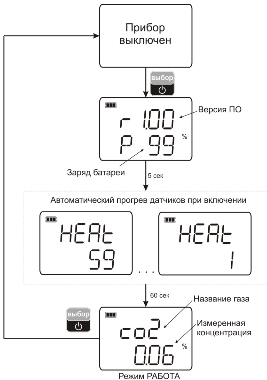
Рисунок 5.1 Схема режима РАБОТА
