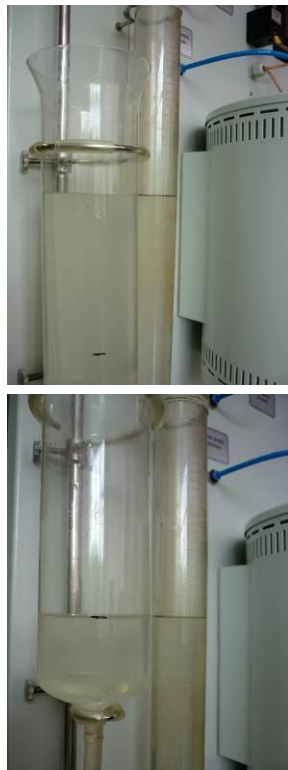
Рисунок В1.2 – Измерение объема газа в газометре
