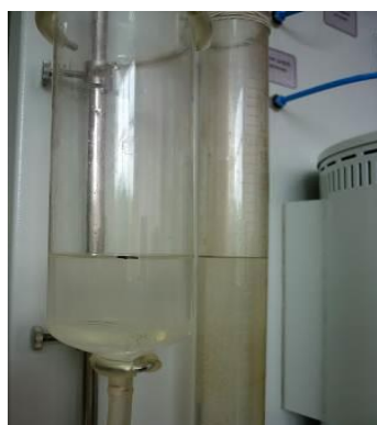
Рисунок 19 – Измерение объёма газов в газометре
