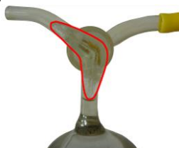
Рисунок 8 – Кран газометра открыт
