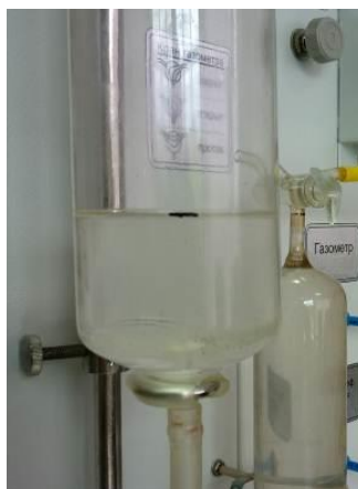
Рисунок В1.1 – Заполнение газометра водой
