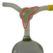
Рисунок 11 – Кран газометра закрыт
