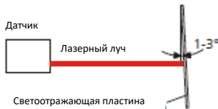
Рис. 23. Монтаж отражательных пластин
