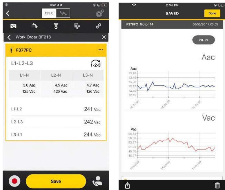
Fluke Connect представляет все результаты измерений параметров трехфазной системы, включая чередование фаз, в виде полного набора данных для наглядного и быстрого анализа.
