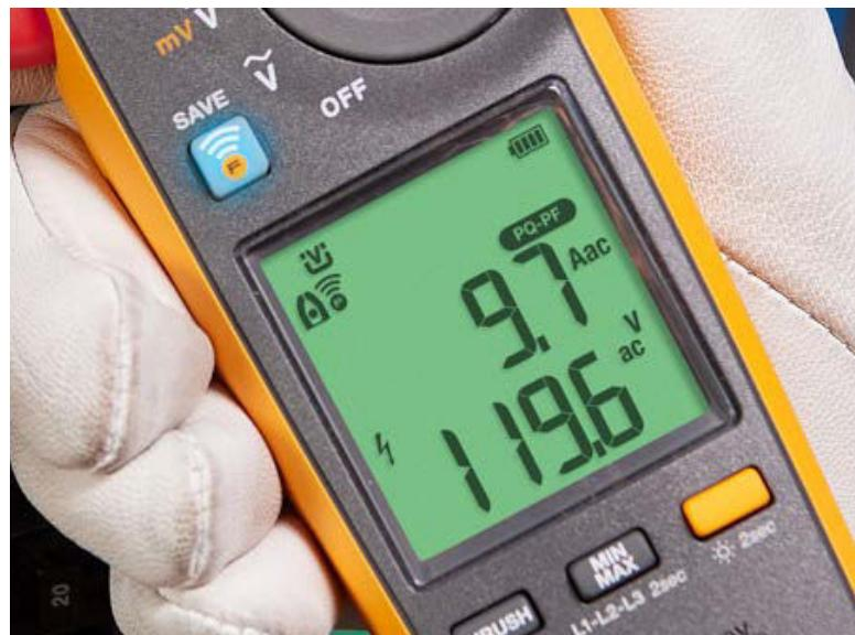
Клещи 378 FC оснащены функцией определения качества электроэнергии, которая помогает быстро определить источник проблемы — объект измерения или питающая линия.
