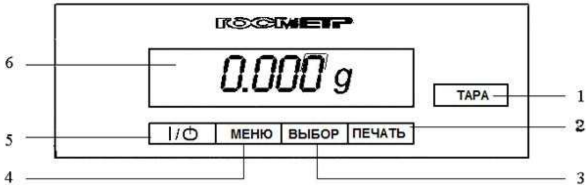
1 - клавиша TAPA, 2 - клавиша ПЕЧАТЬ, 3 - клавиша ВЫБОР, 4 - клавиша МЕНЮ, 5 - клавиша вкл/выкл «I/O», 6 - дисплей.
