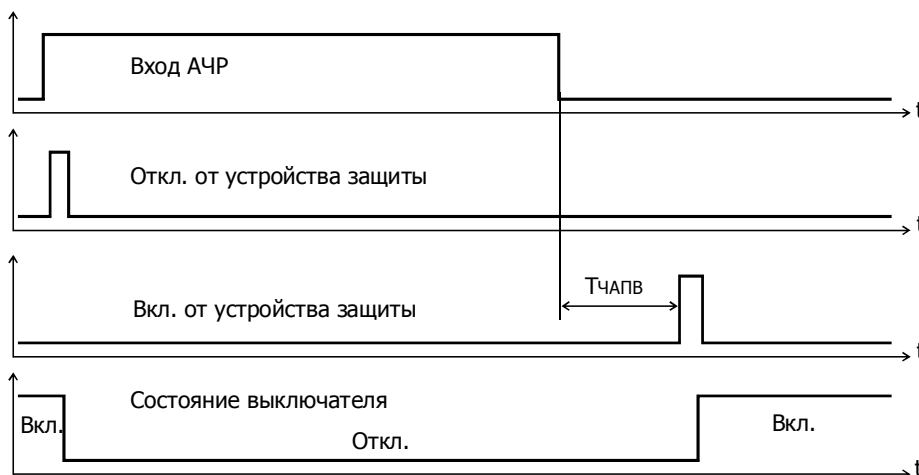
б) Принцип работы АЧР и ЧАПВ при «внутреннем режиме ЧАПВ»
