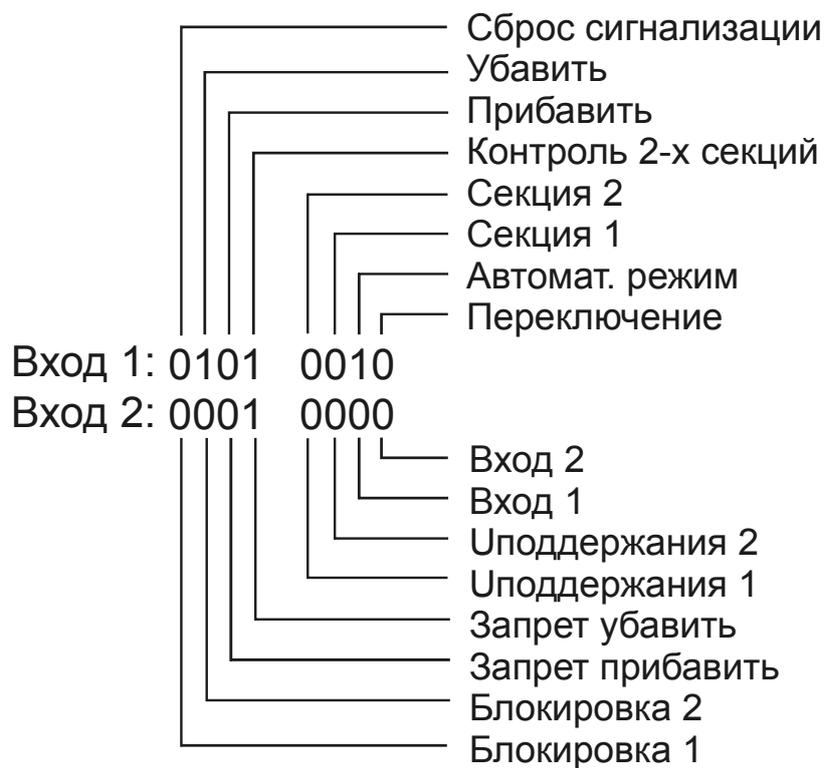
Рисунок К.1 – Соответствие входных дискретных сигналов в режиме «Контроль входов». Активному состоянию соответствует «1», пассивному – «0»
