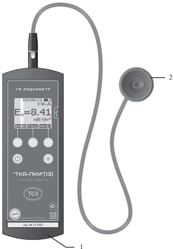
Рис.1 – Внешний вид прибора “ТКА-ПКМ”(13) 1 – Блок обработки информации 2 – Измерительная головка
