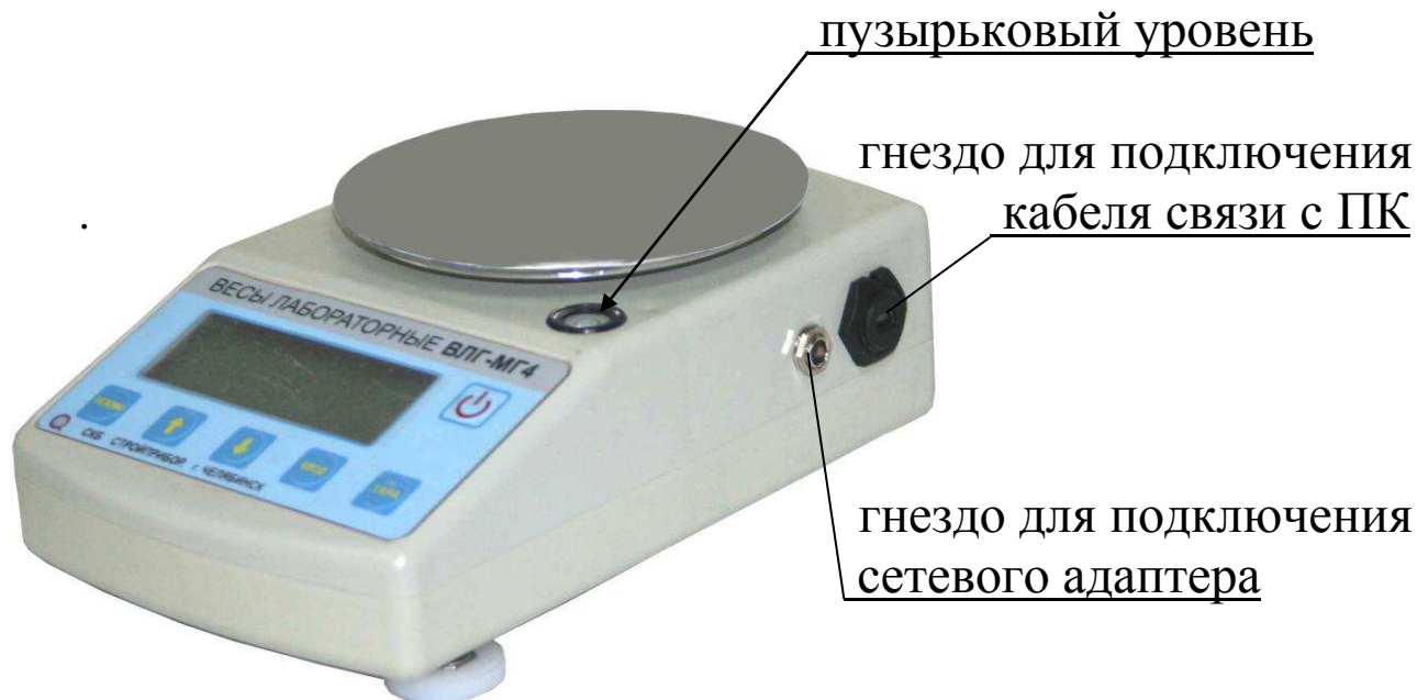
Рисунок 1 - Общий вид весов ВЛГ-МГ4, ВЛГ-МГ4.01 с НПВ до 3000 г
