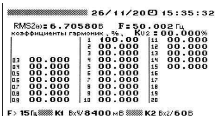
Рисунок 3.13- Режим отображения субгармонических составляющих напряжения
