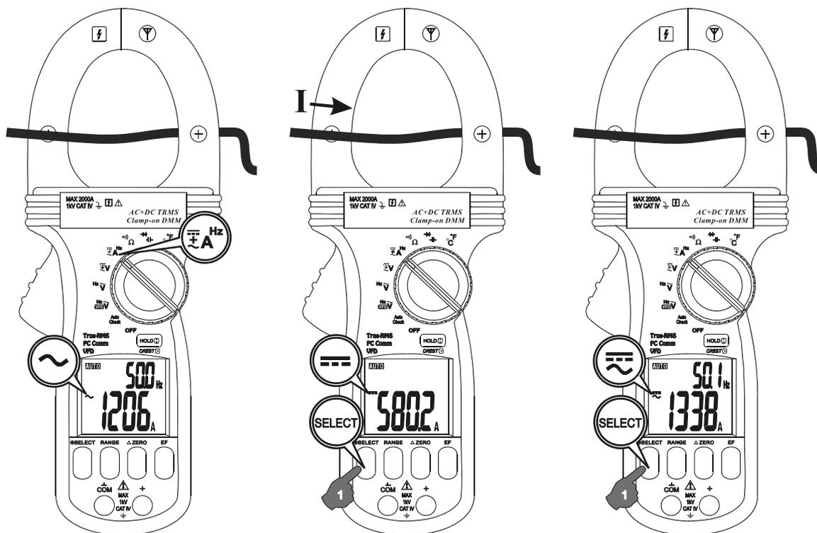
Die Eingabe erfolgt für nicht-invasive Strommessungen über die Stromzangenbacken. Standardeinstellung auf **ACA Hz**-Funktion. Drücken Sie die Taste **SELECT** und lösen Sie sie wieder, um die Funktionen nacheinander anzuzeigen und auszuwählen.
