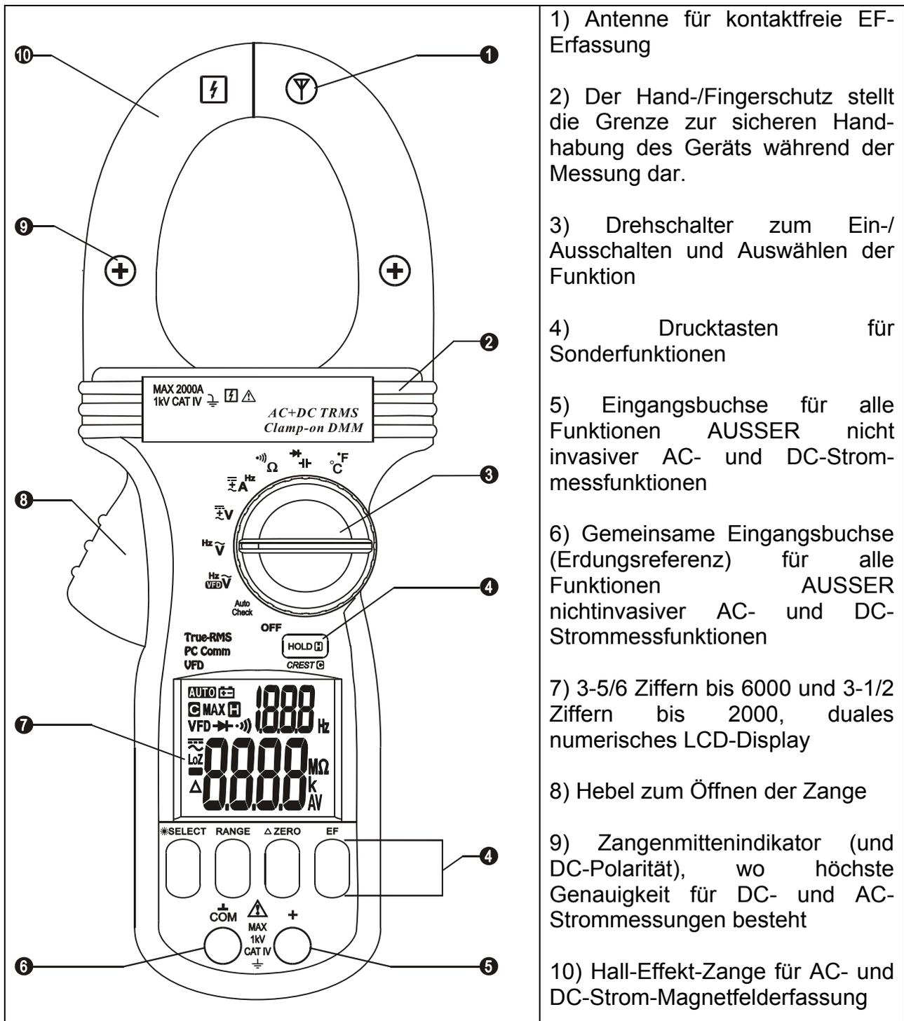
1) Antenne für kontaktfreie EF-Erfassung
