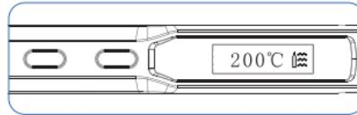
Когда датчик паяльника фиксирует перемещение в пространстве, он автоматически переходит в рабочий режим
