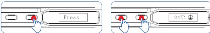
Если на дисплее отобразится «Cal V» - калибровка прошла успешно, если отобразится «Cal X» - ошибка калибровки, необходимо переустановить или заменить наконечник. После успешной калибровки паяльник возвращается в режим термометра.
