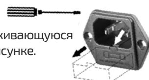
**ЗАПРЕЩАЕТСЯ** устанавливать предохранитель большего номинала или перемычку возможно возгорание прибора или повреждение электросетей. В случае нарушения производитель не несёт ответственности.
